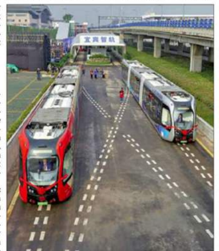
Schienenlose und autonome Straßenbahnen wurden in Südwestchina in Betrieb genommen. Die Stadtbahn in Yibin in der Provinz Sichuan folgt einer eigenen Spur auf der Straße und fährt auf Gummireifen.
